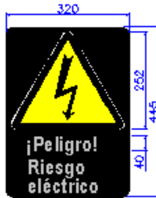
Figura 02: Detalle de Señalización y Rotulación de una Estructura en Media Tensión
